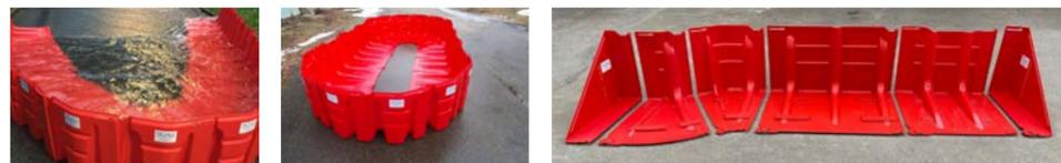
Bei diesem neuen Sandsackersatzsystem handelt es sich um ein freistehendes, mobiles Hochwasserschutzsystem. Die L-förmigen Winkel, die aus einer längeren Grundplatte und einer senkrechten Stauwand bestehen, werden einfach in Reihe gesteckt – es ist kein zusätzliches Zubehör oder Werkzeug notwendig. Die Verankerung und Stabilisierung erfolgt dabei ausschließlich durch das Gewicht des ansteigenden Wassers. Das System kann jederzeit beliebig erweitert und unterschiedlich zusammengestellt werden.
