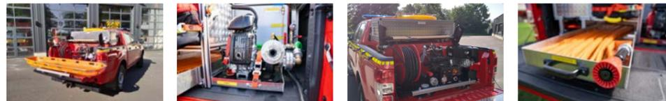
Die verlässlichen Löschmodule (Skid-Unit) von Vallfirest wurden für die Brandbekämpfung entwickelt.
