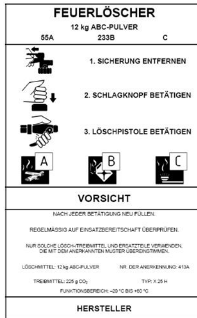
Abb. 1: Beispiel für die Beschriftung eines Feuerlöschers
